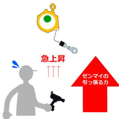
ワークをスプリングバランサーから無理やり外すとゼンマイが引っ張る力で、ワークを吊っていたフックは急上昇しワイヤロープはケースの中に急速に巻き取られます。
