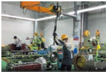
フライホイールの組付け作業に使用される電空バランサー
