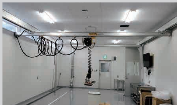
「電空バルンサー まじかるくん 平面吸着ジグセット」を使用し、ダンボールをパレットに搬送
