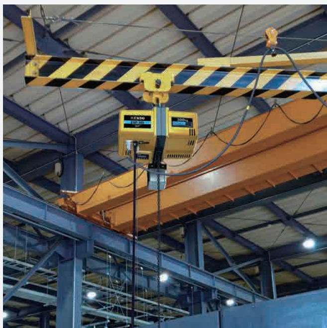
└ イーザーポジショナー + レールシステム (ジブクレーンタイプ)
