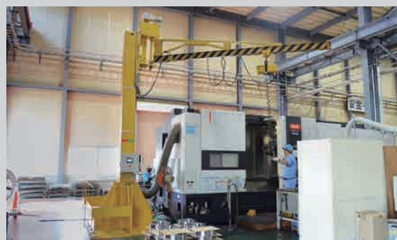
「サーボバルンサー」を使用し、ワークを加工機へチャッキングするための搬送
